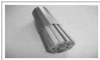
*In solche Leerrohre werden später Glasfaserkabel eingezogen, die den Zugang zum Internet mit über bis zu einem GBit/s im Up- und Download ermöglichen.*
